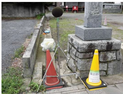
環境騒音測定の様子
