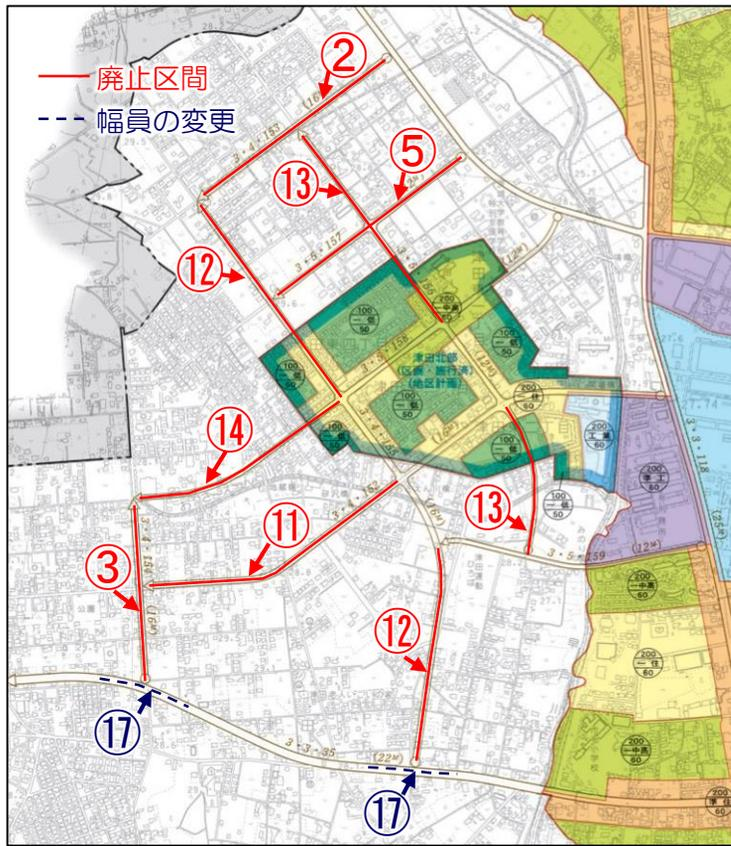
左図赤線区間の廃止，青破線区間の幅員変更
