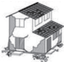
ひび割れ・亀裂
