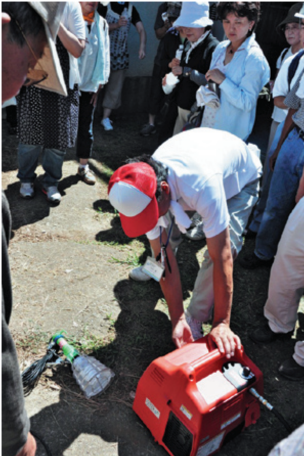
防災倉庫に配備したプロパンガス式発電機
