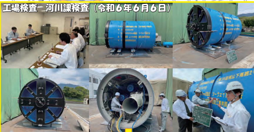
◀左の写真は、工場検査状況：上段の左から、掘削機諸元説明→掘削機①：側面→掘削機②：全体→掘削機③：全面→掘削機④：裏面→掘削機⑤：確認 ▼下の写真は、掘削機現場搬入状況：左から、搬入→吊上げ①→吊上げ②→吊上げ③→吊上げ④→立坑内に設置
