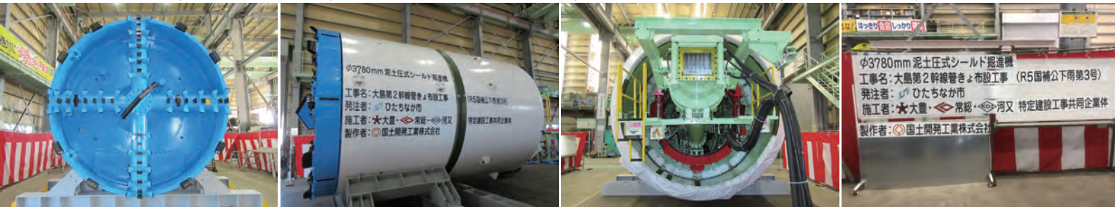
▲上記左から、工場検査の説明、シールドマシンの検査状況、シールドマシンの検測、オペレーター装置の説明です。
