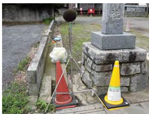
環境騒音測定の様子
